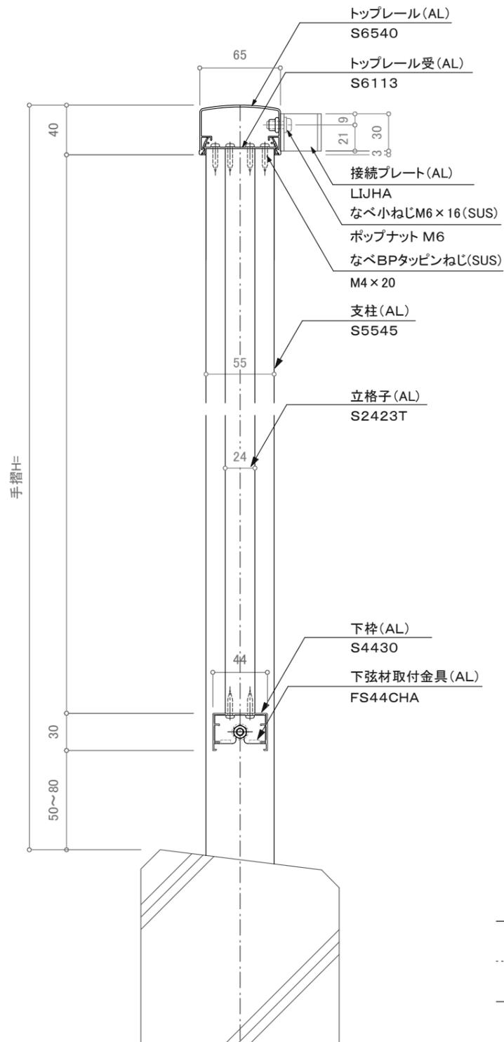
棟上導体システム手すり アース接続端子納まり
