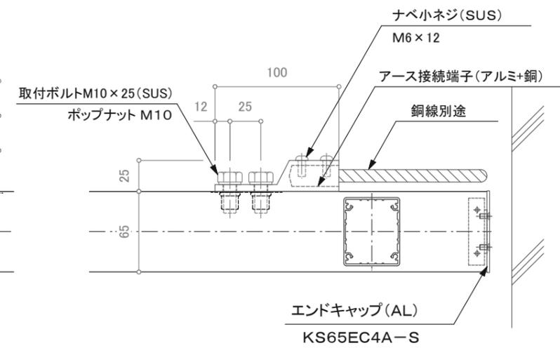
端部アース接続端子部 平面詳細図
