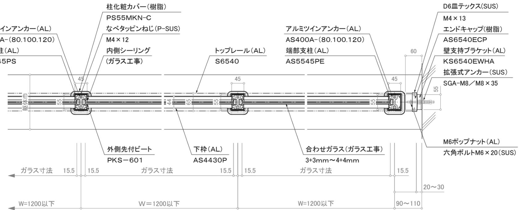
※注意：支柱ピッチは水平荷重強度及び耐風圧強度により異なります。
