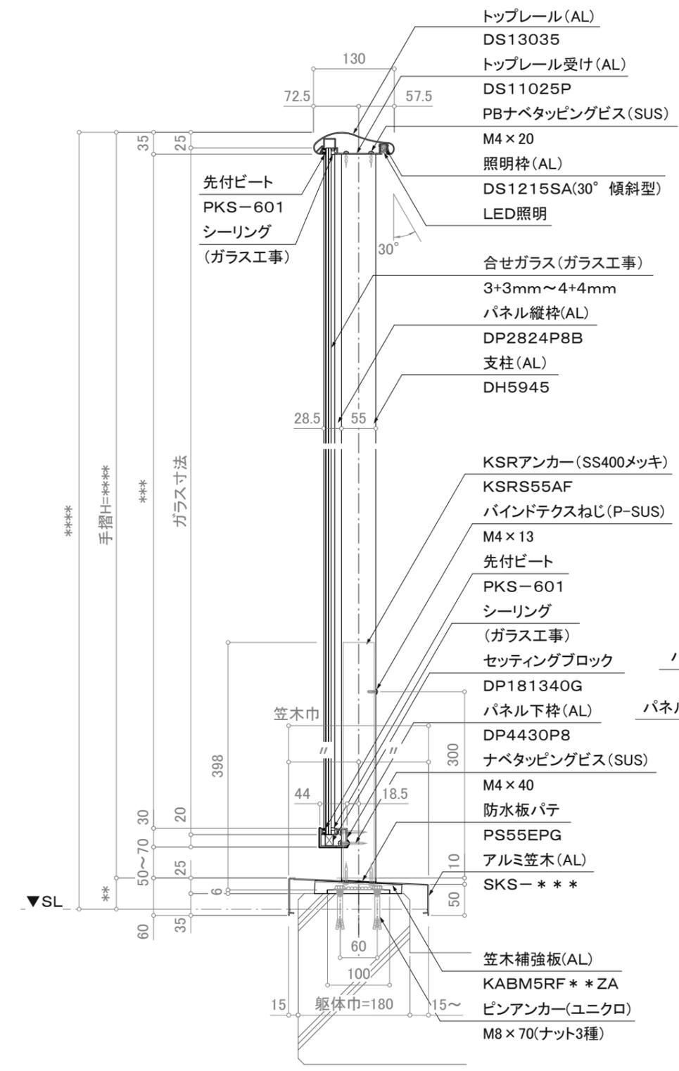
※注意: 支柱ピッチは水平荷重強度及び耐風圧強度により異なります。
