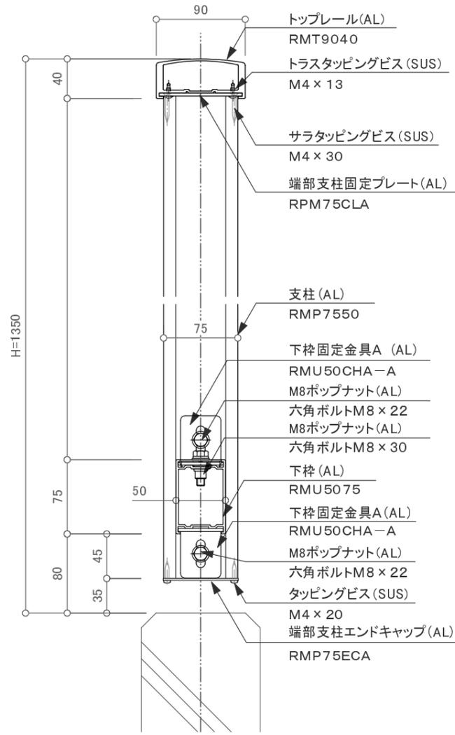
端部支柱部 断面図 S=1/5
